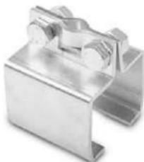
Отличие данного типа захвата от захвата базового состоит в том, что он может быть оснащен резьбовым подвесом, состоящим из крепежных изделий (болта, гаек, шайб). Фиксация направляющей внутри захвата обеспечивается затяжкой двух фиксирующих гаек. Рекомендуется использовать совместно с кронштейнами 261, 262.
