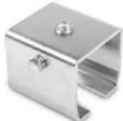
Держатель оснащен гайкой с внутренней резьбой для установки на резьбовой подвес. Наличие боковых резьбовых фиксаторов обеспечивает надёжное крепление направляющей в держателе.
