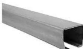
Направляющие прокатываются из качественной высокопрочной стали S355 с высоким показателем прочности и свариваемости. Допуски на размеры выполняются в соответствии с европейским стандартом EN 10162. Направляющая EBPO прокатывается на специализированном прокатном стане, что гарантирует стабильную геометрию и точность.
