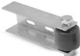
Кронштейн опорный устанавливается для дополнительной боковой опоры створки ворот при слишком близком ее положении во время движения вдоль ограждения или здания. Пара кронштейнов опорных применяется для удержания створки откатных ворот с верхними декоративными элементами. В конструкции кронштейна опорного предусмотрен ролик резиновый.
