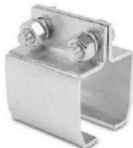
Захват базовый используется для фиксации направляющей и устанавливается на отвесную плиту (планку) при помощи болтового соединения. Форма элементов захвата обеспечивает устойчивое крепление подвесной направляющей внутри захвата.
