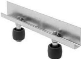
Кронштейн универсальный крепится на П-образную раму с помощью качественных саморезов (в комплекте), что значительно упрощает монтаж. Для тяжелых ворот рекомендуется установка кронштейнов универсальных с обеих сторон П-образной рамы.
