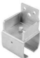
Держатель с боковым креплением используется для фиксации направляющей и устанавливается на плоскую боковую поверхность при помощи анкерного или болтового соединения. Наличие боковых резьбовых фиксаторов обеспечивает надёжное крепление направляющей в держателе.
