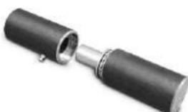
Петли со встроенным подшипником применяются для распашных ворот и калиток. Крепление производится при помощи сварки к столбу и створке ворот (калитке). Петли оснащены масленкой, которая предоставляет возможность смазки внутренних частей петли без ее разборки.
