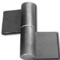
Петли со встроенным подшипником применяются для распашных ворот и калиток. Прямоугольные пластины петли равномерно распределяют нагрузки в процессе эксплуатации. Крепление производится при помощи сварки к столбу и створке ворот (калитке). Петли 834.Л/П оснащены масленкой.
