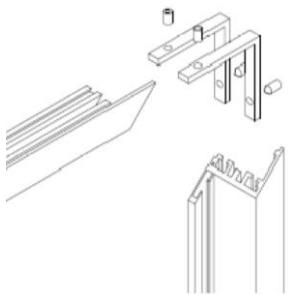
Перед установкой профиля в проем нужно по линии сверления, просверлить отверстия с шагом 300 мм, выполнить зенковку отверстий. Далее соедините дверной профиль уголками крепления (каждый уголок вставляется в отдельный паз). Закрепите их в профиле специальными винтами, которые поставляются в комплекте с угловым соединителем.
