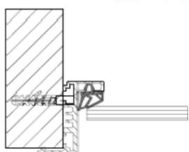
Собранныю дверную коробку поместите в дверной проем и выровняйте по проему. С помощью саморезов 4,5\*50 закрепите дверную коробку в проеме. После чего вставьте резиновый уплотнитель в паз, который располагается рядом с притворной частью профиля.
