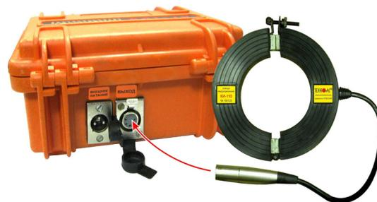
4.15.2 Работа прибора с передающими «клещами» аналогична работе с «клипсами» («кабелем выходным» с разъемами «крокодил»). Соответственно индицируются: напряжение сигнала на «клещах» «U, В» / ток сигнала в «клещах» (не в коммуникации) «I, А» / мощность потребляемая «клещами» «Р, Вт» / импеданс «клещей» (не коммуникации) на данной частоте «R, Ом/кОм». Ток, потребляемый «клещами», обратно пропорционален частоте сигнала при неизменном его напряжении.
