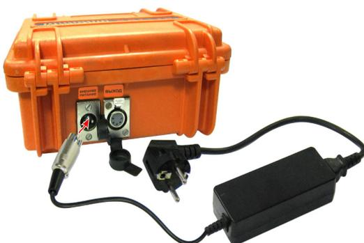
2) **Сетевой блок питания АГ1 14М.02.020** (на базе GS60A15-P1J «MEAN WELL») питается от сети 220В и выдает постоянное напряжение 15В  $\pm 3\%$  при токе до 4А.
