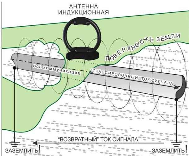
расположить ее как можно ближе к исследуемой коммуникации и в одной плоскости с ней. Не следует пользоваться трассоискателем вблизи расположения передающей антенны во избежание непосредственной индукционной связи (помимо коммуникации).
