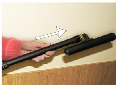
Для изменения положения электромагнитной антенны относительно штанги необходимо ослабить фиксирующую гайку, установить антенну в нужное положение. Зафиксировать положение фиксирующей гайкой.
