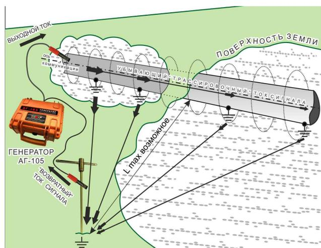
**ПРИМЕЧАНИЕ** для «бесконтактных» способов подключения («LC» / «АН» / «клещи»).
