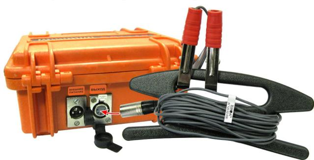
4.12.1 Если «клипсы» подключены к разъему «ВЫХОД», то прибор готов к «контактному» подключению нагрузки. Встроенная передающая антенна «LC» отключена (индикатор «АНТЕННОГО» режима «
