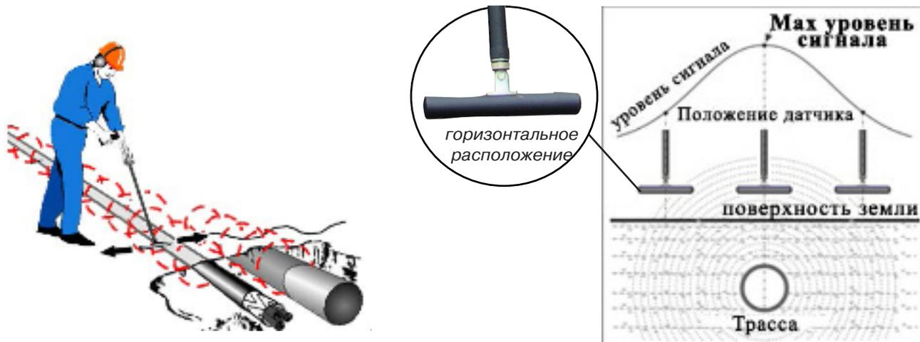
Продвигаясь вдоль трассы, оператор перемещает электромагнитный датчик поперек трассы в одну и в другую сторону для определения точек с максимальным уровнем сигнала. При этом максимум сигнала будет наблюдаться при нахождении антенны датчика непосредственно над коммуникацией.
