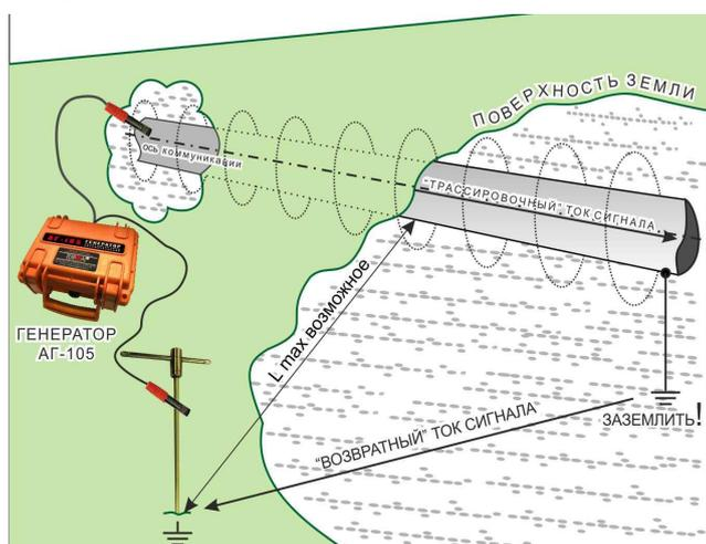
Используются «клипсы» («кабель выходной» с зажимами «крокодил») и штырь заземления. Следует подключить один зажим к входу исследуемой коммуникации, а второй к штырю заземления (или к подходящему заземлению например, к стандартной шине), максимально далеко от коммуникации. Здесь важно обеспечить хорошее контактирование с коммуникацией и с землей.
