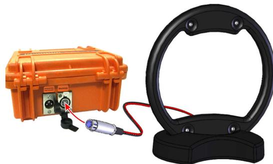
4.14.3 Для максимальной интенсивности «наводки», линия коммуникации и рамка антенны должны быть расположены как можно ближе друг к другу и в одной плоскости.
