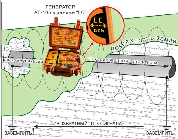
**2) Если используется встроенная передающая антенна «LC»,** то следует расположить корпус прибора точно над исследуемой коммуникацией (установить ориентир «LC-ось» на лицевой панели над осью коммуникации и параллельно ее направлению). Не следует пользоваться трассоискателем вблизи расположения генератора во избежание непосредственной индукционной связи (помимо коммуникации).
