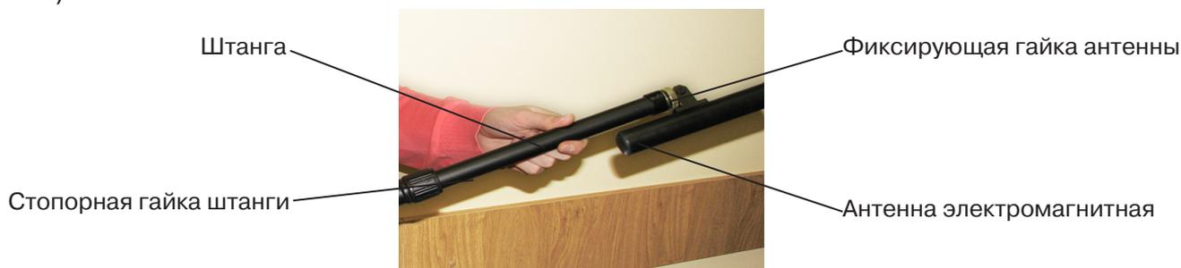
Штанга ЭМД для удобства транспортировки выполнена раздвижной. Антенна электромагнитного датчика может принимать три положения относительно штанги: под углом 0°, 45°, 90°.
