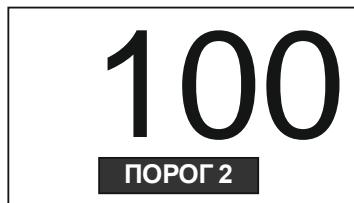
При индикации значений ПОРОГ 1 и ПОРОГ 2 происходит срабатывание звуковой, световой и вибrosигнализации, с соответствующей интенсивностью вибрации, частотой звуковой сигнализации и частотой мигания светодиода.
