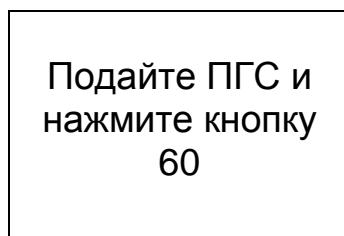
В процессе обратного отсчета нажмите кнопку РЕЖИМ, газоанализатор перейдет к установке чувствительности по окружающему воздуху. Дисплей имеет вид (установки значения 20,9 через компьютер не требуется):
