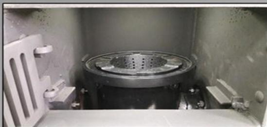
Поворотная чугунная ретортная горелка устанавливаемая по заказу. Главное отличие от стандартной в подвижной чаше горелки на которой происходит горение. Предназначена для угля с высоким уровнем шлакования, но так же может сжигать и пеллеты.
