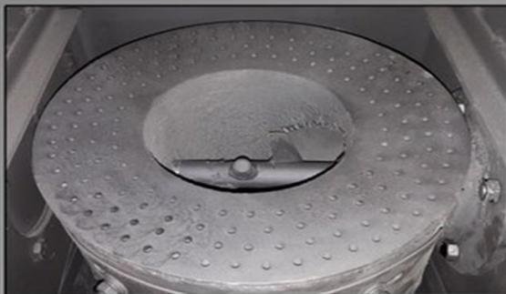
Стандартная горелка устанавливаемая в котлы GREEN LUX. Горелка ретортная,чугунная. За счет использования чугуна имеет большой срок службы относительно стальных горелок и позволяет использовать топливо высокой калорийности. Большая площадь горения обеспечивает хороший запас мощности. В качестве топлива используется уголь фракции и пеллеты.
