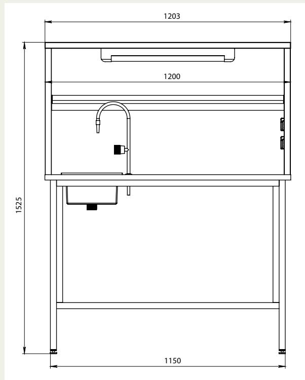
Пристенный ХИМИЧЕСКИЙ СТОЛ отличается от ФИЗИЧЕСКОГО — наличием подвода воды. В базовую комплектацию входит: Сливная раковина из полипропилена 150x300 мм. (сифон и гофрированная труба в комплекте), химически стойкий моно-смеситель для подвода холодной воды.
