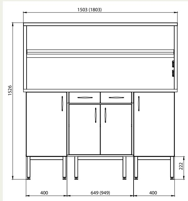
В основе пристенного физического стола **1200 ПФ (Л)Т** — Опорная тумба на металлическом каркасе. На него установлена рабочая поверхность размером 1200x800 мм. На столешницу установлен технологический стеллаж.
