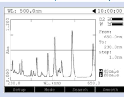
Сканирование спектра это удобный инструмент для научных лабораторий. Микропроцессор прибора позволяет проводить сканирование с учетом широкого списка настроек. Шаг сканирования: 0,1;0,2;0,5;1;5 нм. Скорость сканирования Высокая, Средняя, Низкая (3000 -100 нм/мин).
