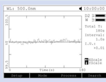
В этом режиме Пользователь может измерять оптическую плотность образца непрерывно в течении длительного времени. Отложенное время начала сканирования может составлять 12 часов. Интервалы получения значений оптической плотности 0,5;1;2;5;10;30 секунд и 1 минута.
