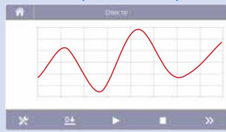
В режиме «Спектр» (только для модели УФ-1800) Пользователь может получить зависимость оптической плотности образца от длины волн в нужном ему интервале. При настройке пользователь может выбрать необходимый интервал длин волн; шаг сканирования (0,1; 0,2; 1,0; 5,0 нм); Скорость сканирования (медленно, нормально, быстро) и режим отражения данных (Abs; T%).
