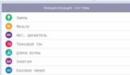
При каждом включении прибор автоматически проверяет работоспособность всех систем: ламп, фильтров тонкой настройки длины волны, двигателя автоматического кюветодержателя (для модели УФ-1800), детектора и двигателя монохроматора. Так же при каждом включении проводится юстировка монохроматора и корректировка базовой линии для обеспечения высокой точности результатов измерений.
