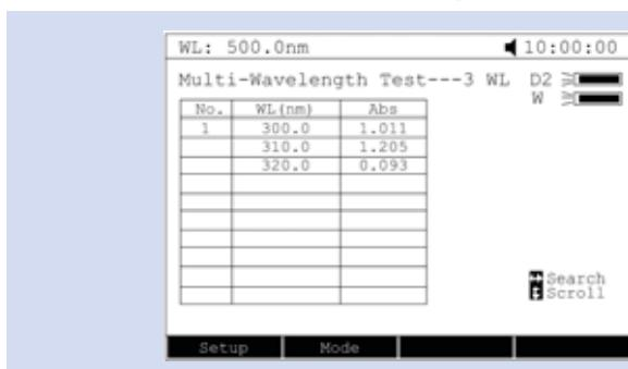
В этом режиме пользователь может определить значение оптической плотности образца сразу по нескольким длинам волн (до 10 шт.). Это очень удобный метод, для исследовательских лабораторий.
