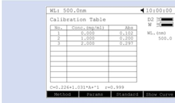
В этом режиме Пользователь может определить концентрацию вещества в растворе. Для определения концентрации нужно создать градиуровку. Градиуровка строится по 2 - 10 точкам.
