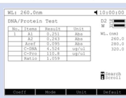
Концентрация и чистота ДНК вычисляются по коэффициенту оптической плотности при 260 нм/280 нм или 260 нм/230 нм с дополнительным вычитанием оптической плотности при 320 нм.
