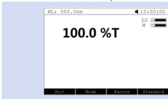
Самый распространенный режим работы спектрофотометра. В этом режиме пользователь может измерить оптическую плотность образца, а также измерить концентрацию с использованием известного коэффициента или одного стандартного образца.
