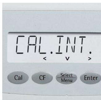
Все предлагаемые весы Sartorius Extend оснащены встроенным калибровочным весом с сервоприводом, благодаря которому высокая точность взвешивания достигается в любое время простым нажатием на клавишу.
