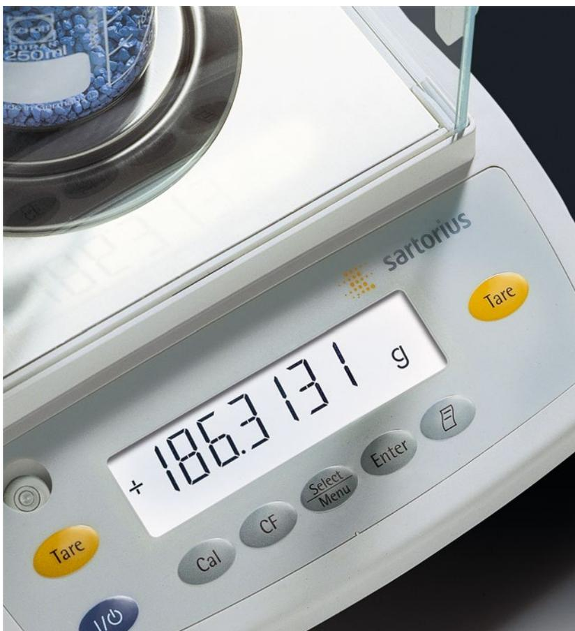
Дисплей весов серии ED сочетает преимущества люминесцентных и ЖК-дисплеев и исключает их недостатки. Высококонтрастный дисплей весов ED благодаря крупным символам (высота 15 мм) и фоновой подсветке позволяет надежно считывать результаты взвешивания при любом освещении.
