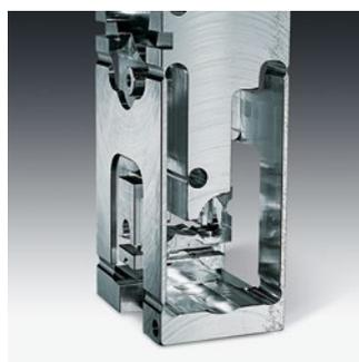
Сердце весов Sartorius — весовая ячейка "Монолит", изготовленная резанием из единой металлической заготовки. За счет ячейки "Монолит" весы Sartorius ED обладают повышенным быстродействием и улучшенной воспроизводимостью результатов.
