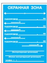
Закрепление трассы газопровода на местности
