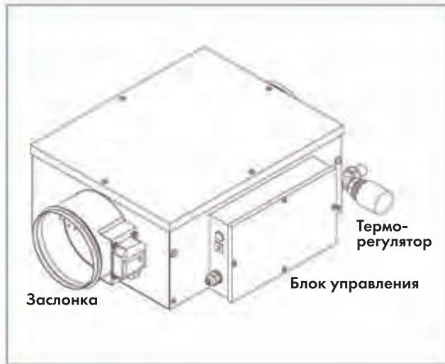
Приточно-вытяжные вентиляционные установки Econom соответствуют требованиям ГОСТ 6033-2-40-2000, ГОСТ 3 51318.1.14-99. По условиям эксплуатации установка Econom имеет следующие параметры:
