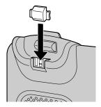
• Трубка будет надежно зафиксирована на рычаге.
