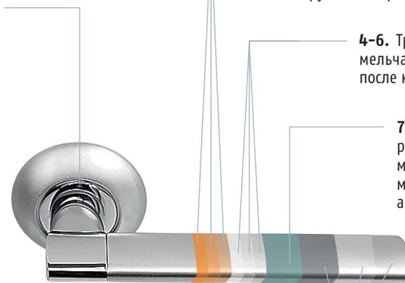
**1-3.** Первые три слоя, покрывающие основу будущей ручки, – медные. Они повышают адгезию между конструкционным материалом ручки и выравнивающим слоем.
