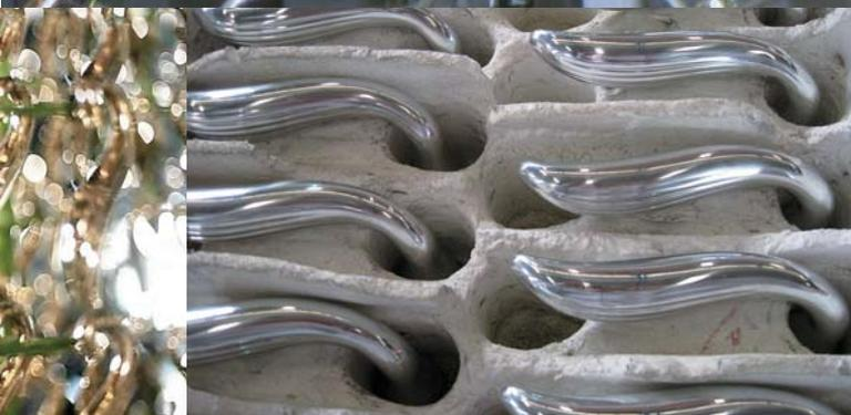
Заготовки будущих изделий подвергаются двухступенчатому процессу шлифовки: сначала удаляются шероховатости, а потом изделие проходит процесс тонкой шлифовки на специальном оборудовании, благодаря чему поверхность приобретает идеальную гладкость.
