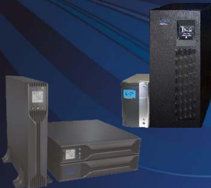
Принцип работы онлайн ИБП построен на двойном преобразовании электропитания: входное напряжение трансформируется в постоянное, а затем обратно в переменное при помощи обратного преобразователя – инвертора. Постоянное напряжение на выходе выпрямителя также используется для заряда батарей.
