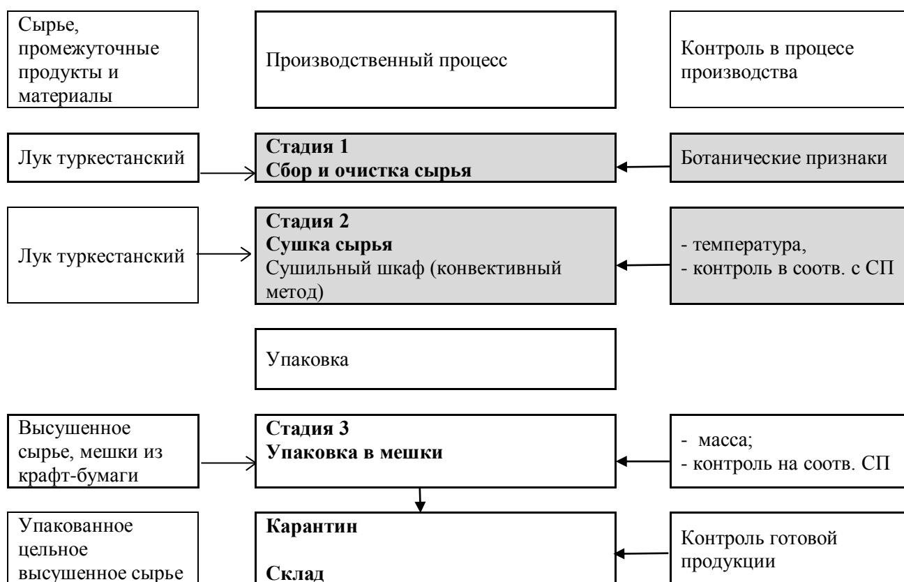
Рисунок 2 – Технологическая схема заготовки и сушки лука туркестанского
