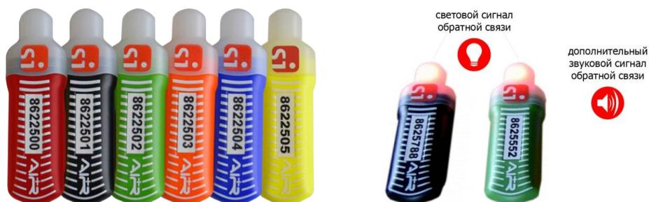
SIAC содержит батарею и отличается чрезвычайно низким энергопотреблением. Чип всегда может работать в режиме контактной отметки, даже если батарея разряжена. Расчетное время автономной работы батареи составляет около 4 лет, если чип используется примерно 40 раз в год на соревнованиях по ориентированию. Батарею можно заменить в авторизованных сервисных центрах SPORTident ([www.SPORTident-RUSSIA.ru](http://www.SPORTident-RUSSIA.ru)).
