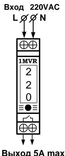
**Контакт выходного реле (конфигурация 1A, 250VAC \ 5A max) можно использовать в различных схемах автоматики и сигнализации.**
