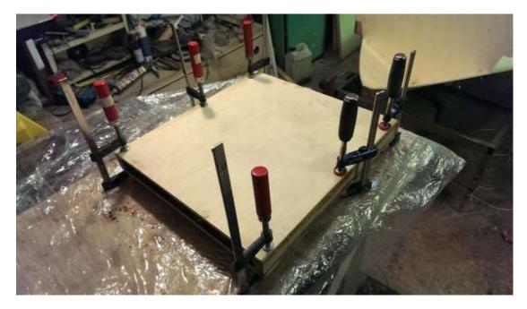
Борта и днище сшиваются друг с другом внутренними кромками и проклеиваются внутри так же, как и днище, системой галтель + 2 слоя ленты. После высыхания шва проволоку можно будет удалить снаружи с помощью плоскогубцев. Но можно обрезать и оставить. Закупоренная в эпоксидный состав медь будет жить практически вечно. Стальную проволоку лучше удалить.
