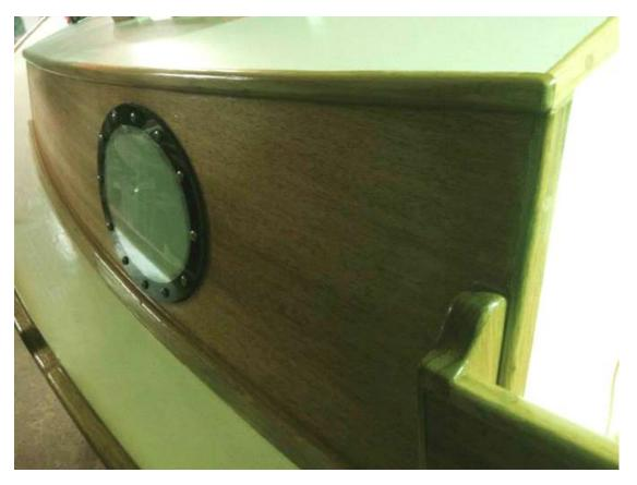
Привальный брус целесообразно сделать ламинированным на клее – из двух дубовых брусьев сечением 50х10 – так легче всего будет гнуть и наращивать нужную длину. Важно, чтобы привальный брус выступал над уровнем палубы как минимум на 15 мм, чтобы создавать упор для ног. Брус монтируется при помощи клея и саморезов.
