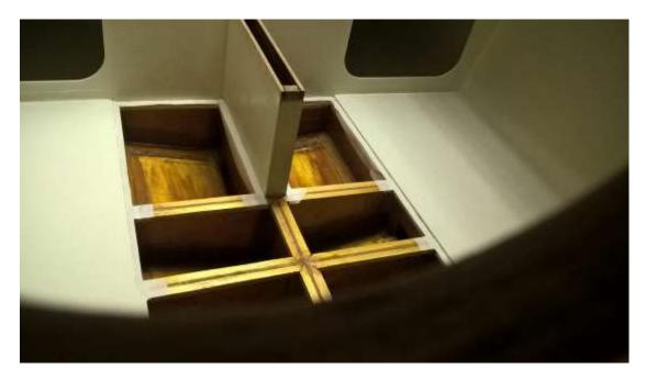
Внутренние стенки швертового колодца проклеиваются стеклотканью 200 гр/м2. После чего шлифуются шкуркой. Передняя и задняя стенки изготавливаются из дубового бруса. Щель колодца должна быть шире и длиннее профиля шверта на 5-6 мм. Например, у Фолькбота 16 толщина шверта 24 мм, соответственно, для изготовления шверт-колодца понадобится 2 бруса сечением 30х30.
