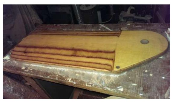
Снаружи стыки бортов, днища и транца слегка скругляются, заделываются эпоксидной шпатлевкой таким образом, чтобы торцы фанеры были полностью закрыты. После чего проклеиваются на три слоя ленты (лента + 2 ленты внахлест).
