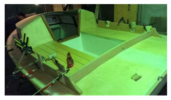
Бимс рубки малкуется, после чего с помощью клея и саморезов монтируется крыша. Стыки крыши и стенок рубки проклеиваются снаружи на слой ленты. Для проклейки лакированных частей можно использовать прозрачный отвердитель ТЭТА, чтобы сохранить цвет и текстуру дерева. Либо торец крыши закрывается штапиком – бруском сечением 15х15.
