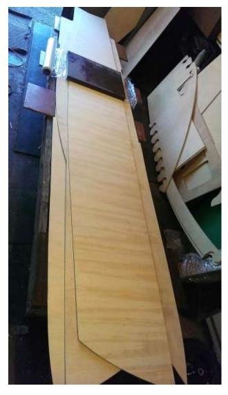
Длинные детали бортов и днища стыкуются с помощью пазлов. Для этого пазлы промазываются эпоксидной смолой и затем стык проклеивается на 3 слоя ленты внутри и снаружи (1 слой + 2 слоя внахлест, общей шириной примерно 80 мм).
