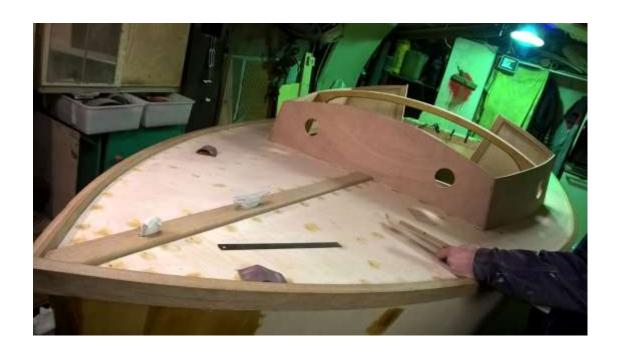
Детали комингсов склеиваются между собой с помощью ПУР501, но только после установки их на место и придания комингсам нужной погиби. Верхние торцы фанеры закрываются дубовым брусом подходящего сечения.
