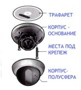
3. ОТРЕГУЛИРУЙТЕ НАПРАВЛЕНИЕ ОБЗОРА, ПЕРЕМЕЩАЯ ШАРООБРАЗНЫЙ МОДУЛЬ С ПЕЧАТНОЙ ПЛАТОЙ И ОБЪЕКТИВОМ. ЗАКРЕПИТЕ КОРПУС-ПОЛУСФЕРУ НА ОСНОВАНИИ МУЛЯЖА, ЗАКРЫВАЙТЕ ДО ЩЕЛЧКА.
