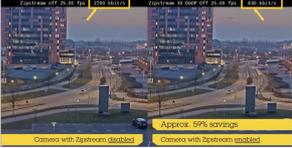
В сетевых видеорегистраторах DIGIEVER появилась поддержка технологии Zipstream компании AXIS. Благодаря технологии Zipstream достигается оптимальное использование доступной пропускной способности сети для передачи данных и объёма дисковых накопителей.
