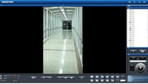
Сетевые видеорегистраторы DIGIEVER поддерживают специальный режим передачи изображения IP-камер VIVOTEK – КОРИДОР (**corridor mode**). Эта настройка разработана для применения IP-камер в различных местах со специфическими условиями видеонаблюдения – коридоры, холлы, тоннели, салоны общественного транспорта.
