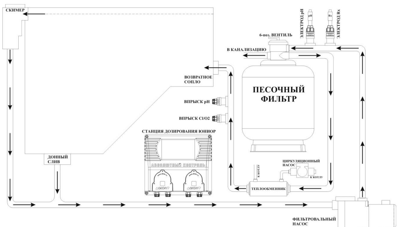
При наличии возможности, рекомендуется приобретать дополнительную пробоотборную ячейку, контролируемую воду не возвращать в систему, а осуществлять сброс в канализацию, на патрубке сброса установите вентиль, для контроля потока, в этом случае подключайте по схеме №2.
