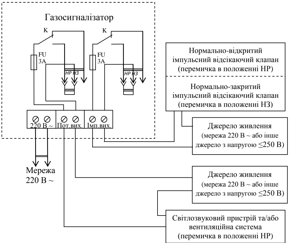
Рисунок 2. Схема підключення газосигналізатора «Страж SxxA2x» (тобто, з типом управляючих виходів № 2) до нормально-відкритого імпульсного відсікаючого електромагнітного клапану (типу EVG/NA, EVRM-NA, M16/RM-NA та ін.), світлозвукового пристрою, нормально-закритого електромагнітного клапану з потенціальним або імпульсним керуванням.
