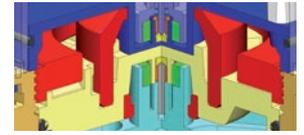
Очень высокая устойчивость водомера Smart к воздействию внешнего магнитного поля SN+ благодаря применению специального магнитного экрана и двух четырехполюсных магнитов магнитной муфты.
