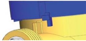
Блокировка вращения счетного механизма, при вращении под углом более 360°.
