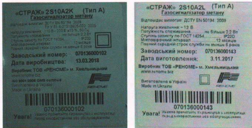
Рисунок 8 – Приклад марковальної таблички газосигналізаторів груп виконань 2С і 2S
