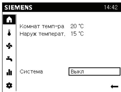
Используйте значение пункта Система “Выкл”, если предполагается длительное отсутствие в помещении или здании. Здание остается защищенным от замерзания. Энергопотребление сокращается до минимального.
