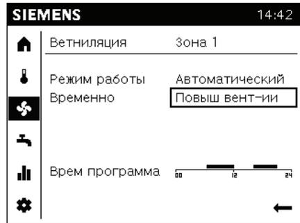
Используйте значения пункта Временно “Повышение вентиляции” для проветривания здания с наибольшим расходом.
