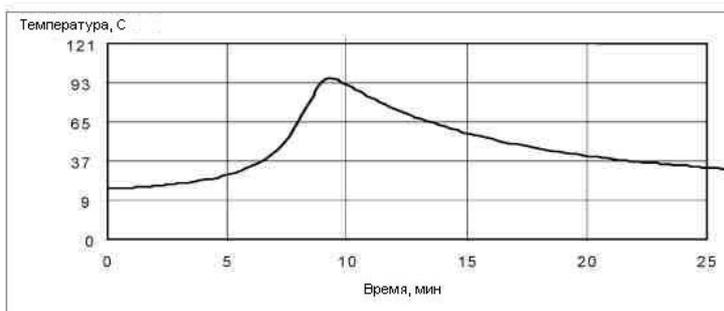
Стандартная экзотермическая кривая для MA420 при 23°C (10 грамм)<sup>5</sup>
