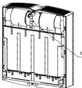
Рисунок 6. Расположение переключателя режима яркости подсветки
