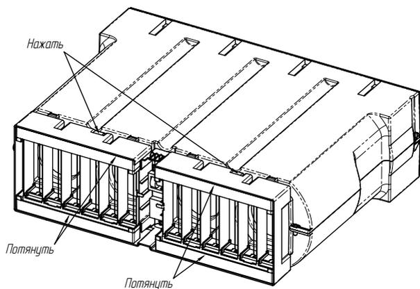
**Рисунок 20. Снятие зарядителя**
