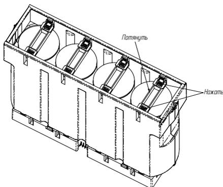
**Рисунок 22. Снятие прижима HEPA-фильтра**
