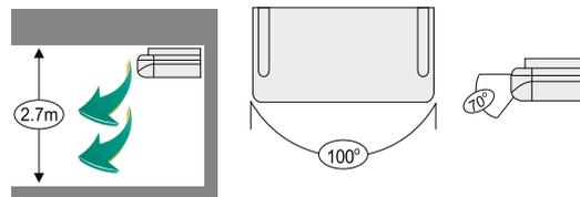
**Автоматическое регулирование воздушораспределения**
