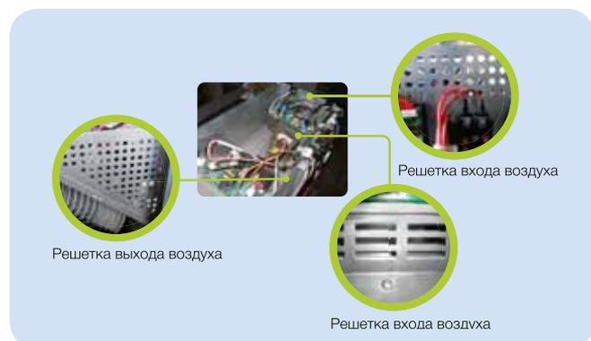
В наружных блоках Super Match (1:3 - 1:5) улучшена система охлаждения электрической секции. За счет увеличения зон обдува удалось существенно снизить температуру в секции, тем самым повысив надежность и долговечность работы электрокомпонентов.
