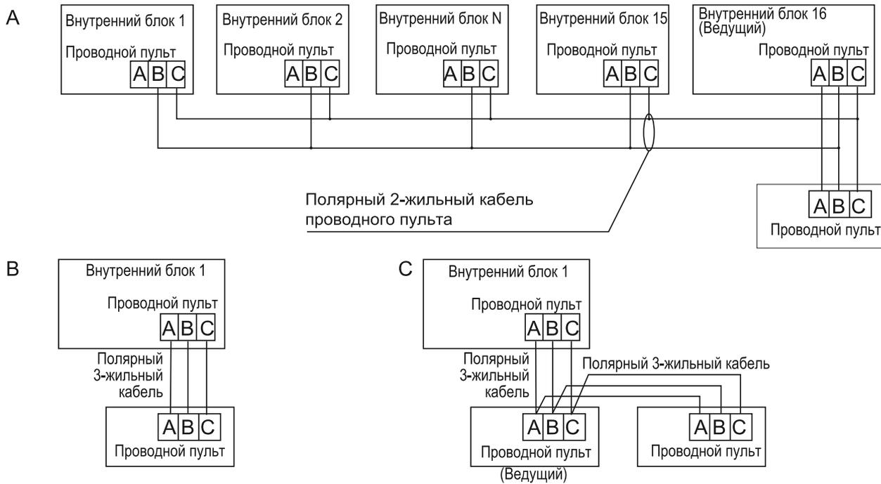
Схема электроподключения блоков Maxi Split
