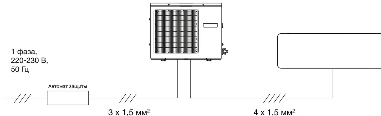
ВСЕ НАСТЕННЫЕ НЕИНВЕРТОРНЫЕ БЛОКИ КЛАССА 7, 9, 12: автомат 16А, электропитание к внутреннему блоку 3 x 1,5 мм<sup>2</sup>, межблочная связь 5 x 1,5 мм<sup>2</sup>
