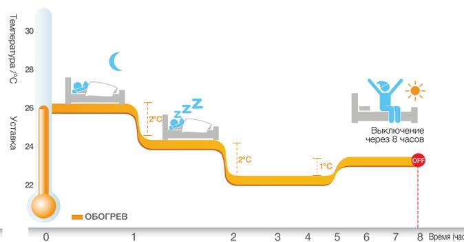
В режиме обогрева температурная уставка снижается на 2°C в течение 1-го часа, затем еще на 2°C в течение последующего часа. Такая температура поддерживается 3 часа, затем повышается на 1°C, и через 3 часа кондиционер выключается.
