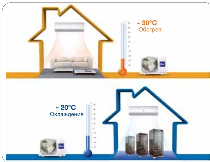
Возможность работы кондиционера в широком диапазоне наружных температур обеспечивается за счет усовершенствования конструкции спаренного ротационного компрессора, высокоэффективного DC-электродвигателя, оптимизированной конструкции основания наружного блока, дополнительного электронагревателя компрессора, специальной программы функции оттаивания и других конструктивных преимуществ.
