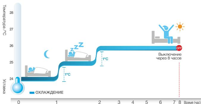
В режиме охлаждения температурная уставка повышается на 1°C в течение 1-го часа, затем еще на 1°C в течение последующего часа. Такая температура поддерживается на протяжении дальнейших 6 часов, после чего кондиционер выключается.
