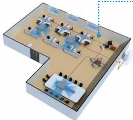
Система Maxi Split предоставляет возможность осуществлять равномерное кондиционирование больших помещений. К одному наружному может быть подключено 2, 3 или 4 внутренних блока кассетного или напольно-потолочного типа. Все блоки работают в одном режиме.
