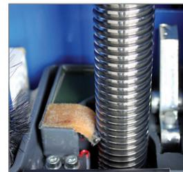
Система смазки узла винт-гайка жидким маслом гарантирует высокую износоустойчивость и удобство в обслуживании.
