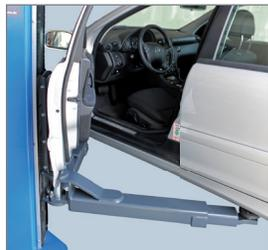
Стойки подъемника разведены на 45° относительно направления заезда, что обеспечивает большой угол открывания дверей автомобиля для удобного доступа внутрь.
