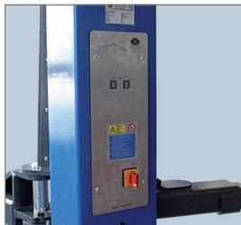
Панель управления встроена в стойку подъемника. В качестве опции предлагается энергоблок с 1 розеткой на 230 В, 1 розеткой сжатого воздуха.
