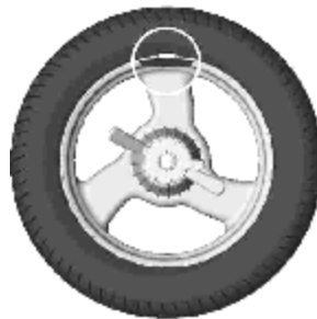
Рисунок 6.3 – Груз установлен в положение «12 часов»
