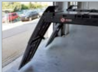
Складные въездные ramпы, если платформы высокие или угол заезда слишком мал
