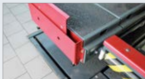
Подъемный пол, расположенный под платформами подъемника, выравнивает поверхность пола, когда подъемник находится над поверхностью.
