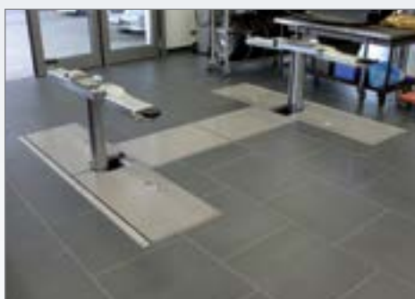
Рамная система с закрывающимися пластинами полностью гальванизирована
