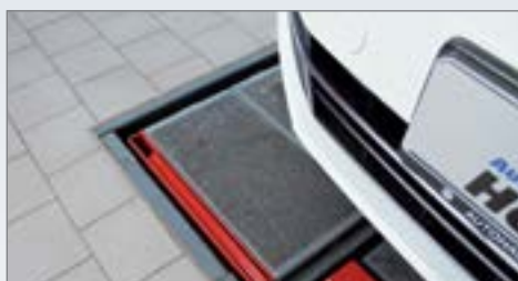
Подъемный пол, расположенный под платформами подъемника, выравнивает поверхность пола, когда подъемник находится над поверхностью.
