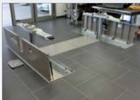
Рамная система с закрывающимися пластинами полностью гальванизирована
