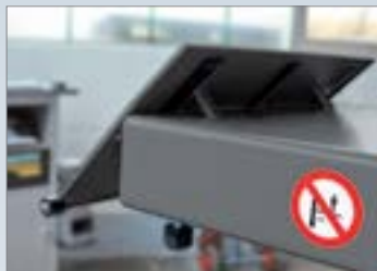
Въездные ramпы при монтаже подъемника вровень с полом
