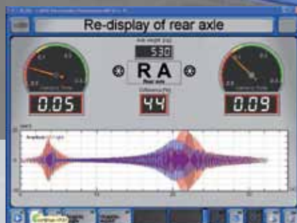
Значимая информация, основанная на примере неисправного амортизатора
