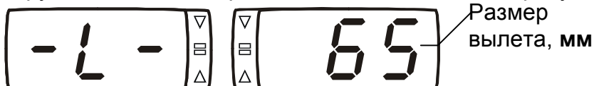
Рисунок 4.3 – Показания индикаторов во время пользования электронной линейкой для измерения вылета (измеритель диаметра выключен)
