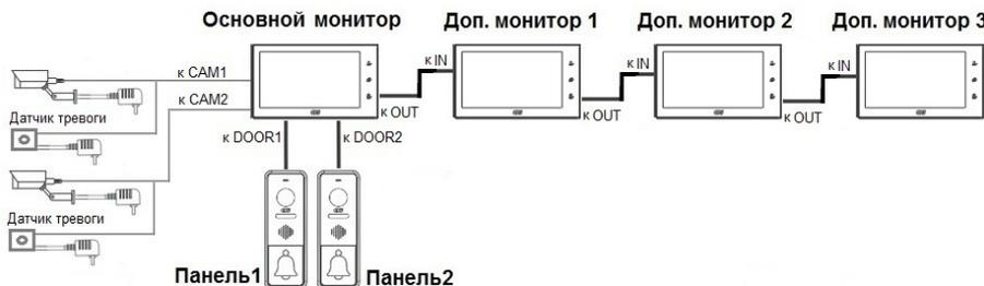
Вызывные панели подключаются только к основному монитору.
