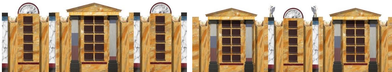
В - фронтальные композиции колумбарных ниш, встроенных в подпорные стенки холма
