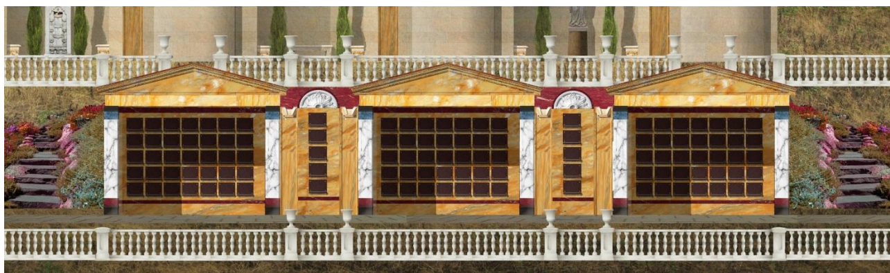
А - стена террасы кремационного парка с зонами отдыха и поминовения и башенными колумбариями, встроенная в подпорную стенку холма
