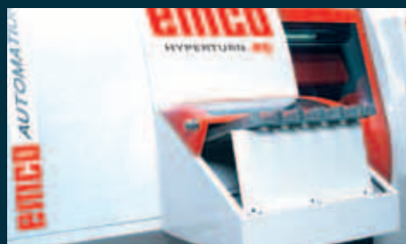
Многолотковый подающий конвейер для деталей типа «вал». Каждый лоток имеет сенсор, определяющий наличие на лотке заготовки.
