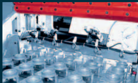
Тактовый подающий конвейер большой емкости для подачи заготовок в зону загрузки.
