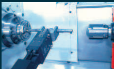
Манипулятор с грейферным захватом для установки предварительно обработанной заготовки в рабочий шпиндель.
