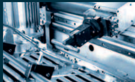
Тактовый подающий конвейер с призмобразными направляющими для подачи в зону загрузки предварительно обработанных заготовок.
