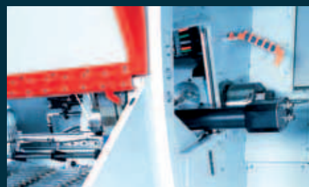
Полностью автоматическая система загрузки в рабочий шпиндель деталей типа «вал».
