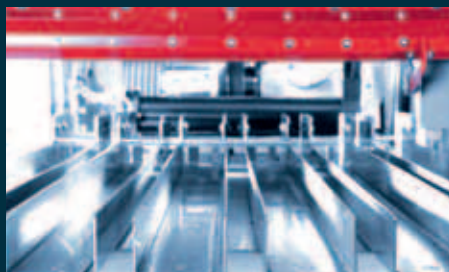
Многолотковый подающий конвейер для деталей типа «вал». Количество подающих лотков находится в прямой зависимости от длины заготовок.
