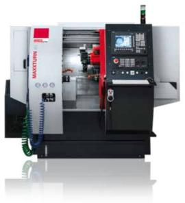
Серия обрабатывающих центров MAXXTURN отлично подходит для комплексной обработки пруткового материала и штучных заготовок. Линейка включает в себя пять вариантов станков, отличающихся высочайшим качеством исполнения. Высокопроизводительный мотор-шпиндель с системой охлаждения, жесткая система подач и большой диапазон перемещения по оси Y, опциональный противошпиндель и современная система ЧПУ дают неограниченные возможности при комплексной обработке деталей различной сложности.
