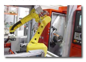
Роботизированный модуль EMCO ROBO LOAD — это законченное решение для автоматической загрузки и снятия заготовок, при этом конфигурация захватного механизма подбирается индивидуально для каждого заказчика в зависимости от номенклатуры обрабатываемых деталей. Модуль выполнен на базе шарнирного робота с шестью степенями свободы. Модулями EMCO ROBO LOAD могут комплектоваться как простые модели токарных и фрезерных станков, так и сложные многоосевые токарно-фрезерные обрабатывающие центры HYPERTURN.
