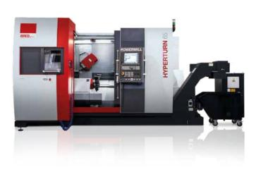
Обрабатывающие центры HYPERTURN POWERMILL нового поколения реализуют возможность комплексной обработки сложных деталей с максимальной производительностью. Станки серии объединяют все передовые технологии в области токарной и фрезерной обработки. Жесткая станина с основанием из композиционного материала HYDROPOL®, охлаждаемый мотор-шпиндель, противошпиндель, поворотный фрезерный шпиндель, и высокопроизводительная система ЧПУ SIEMENS 840D с диалоговым программированием Shop Turn де-
