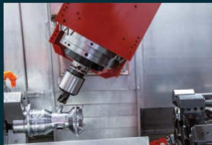
**Фрезерный шпиндель.** Наличие привода с выходной мощностью 29 кВт/7 крутящим моментом 79 Н\*м и макс. числом оборотов до 12,000 об/мин, позволяет HYPERTURN 65 PowerMill выполнять высокотехнологичные фрезерные операции, такие как HSC (высокоскоростное резание) или HPC (высокопроизводительное резание). Тем самым достигается чрезвычайно эффективное выполнение комплексной токарно-фрезерной обработки сложных деталей.
