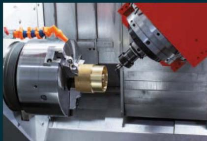
**Главный шпиндель.** С выходной мощностью 29 (37) кВт и крутящим моментом 250 (360) Н\*м обеспечивает возможность обработки прутковых заготовок диаметром до 65 (76/95) мм, и деталей, установленных в патроне диаметром до 250 мм. Механический тормоз гарантирует дополнительную фиксацию обрабатываемой детали для выполнения высокопроизводительного фрезерования.
