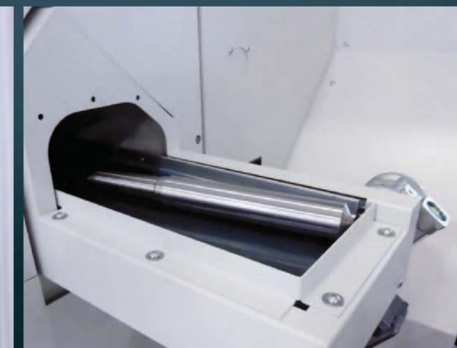
**Транспортер готовых деталей.** На ленте транспортера расположенного вдоль обрабатывающего центра с рабочей площадью 1400 x 180 мм выполняется безопасное размещение обработанных деталей.
