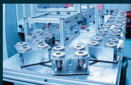
4-позиционная паллета для тарелки клапана
