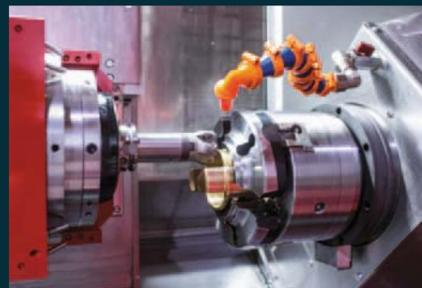
**Контршпиндель.** Подвижный контршпиндель имеет аналогичные характеристики, что и главный шпиндель. Механический дисковый тормоз входит в базовую комплектацию. Кроме того, контршпиндель оснащён выталкивателем деталей с настройкой хода, с функцией подачи СОЖ. Всё это обеспечивает возможность надежного выполнения мехобработки в полностью автоматическом режиме.
