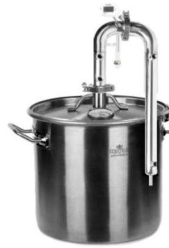
При первой перегонки пары из куба, в котором находится брага, поднимаются вверх по дефлегматору (он не подключен), и попадают в холодильную камеру состоящую из 4 трубок где охлаждаются. В холодильнике они конденсируются и в виде жидкости стекают по шлангу в приемную емкость
