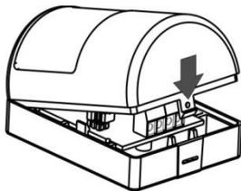
18 При тестировании системы сигнализации в начальный период эксплуатации (1-2 недели) в случае выдачи ложных извещений "Тревога", связанных с особенностями охраняемого помещения, снять перемычку с вилки Sens
