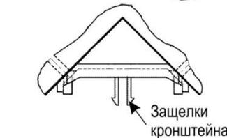
**5б** Установить основание на кронштейн, вставив защелки кронштейна в паз основания извещателя. Основание извещателя ориентировать строго по рисунку действия 3а.
