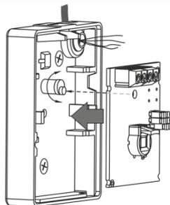
**8** Закрепить подведенные провода в клеммах извещателя
