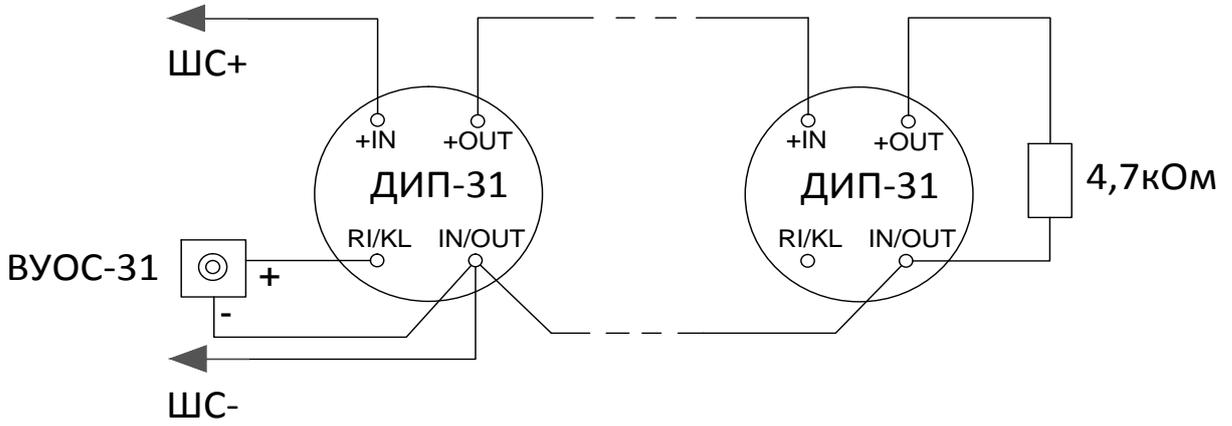
Схема подключения извещателей ИП435-8/101-04-А1R «СОНЕТ» в ШС типа 1 (сверху) и в ШС типа 2 (снизу)
