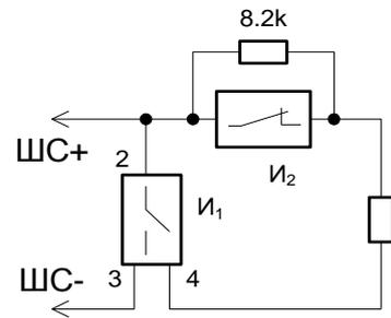
**Схема подключения тепловых извещателей, тип шлейфа 3**
