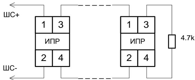
Схема подключения извещателей ИП 212-31 «ДИП-31» в ШС типа 1 и 2
