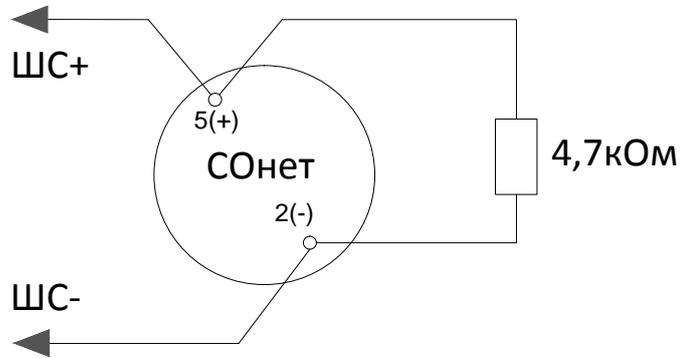
Схема подключения извещателей «ИПР 513-3М» в ШС типа 16
