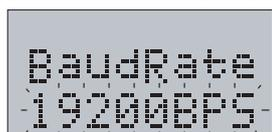
1) Нажмите и удерживайте кнопку STOP около 3-х секунд. На дисплее отобразится установленная скорость обмена данными по интерфейсу RS-232. По умолчанию установлено 19200 бит/с.
