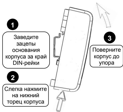
Рисунок 3. Крепление блока на DIN-рейку
