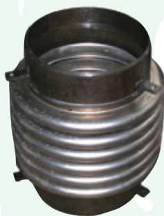
При монтаже КНС в сейсмически опасных районах для компенсации сдвиговых перемещений трубопроводной арматуры применяются компенсаторы сильфонные.
