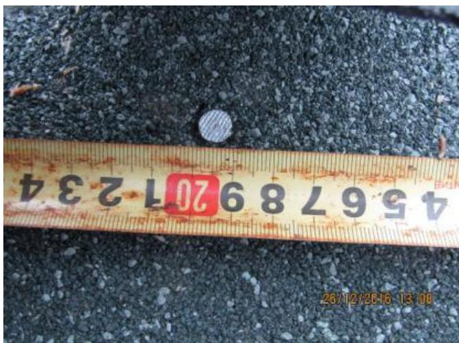
Гвозди коррозионностойкие, длина 30 мм, толщина 3,5 мм, ширина шляпки 9 мм.
