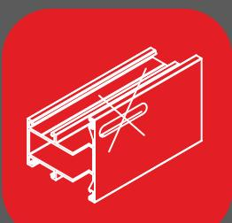
Отсутствие фрезеровок дренажных отверстий в промежуточных горизонтальных импортах
