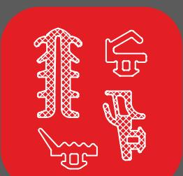
В системе используются доработанные резиновые уплотнители, предотвращающие затекание осадков внутрь
