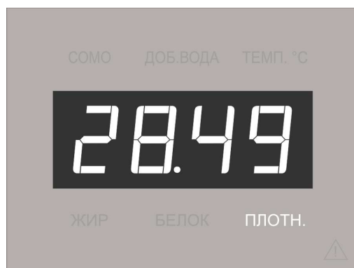
Рисунок 2.9 – Плотность молока 28,49 в градусах ареометра (1028,49 кг/м 3 )
