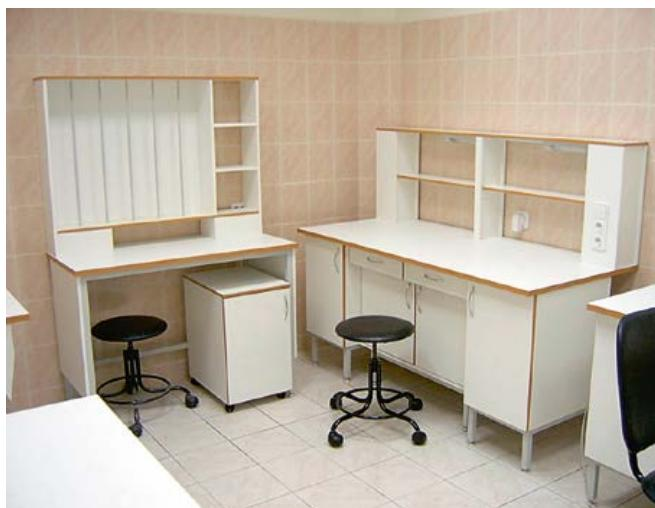
В основе титровального стола **1500 СТ (Л)** две опорные тумбы на металлических каркасах. Одна тумба с тремя выдвижными ящиками, и одна тумба с дверью. На тумбы устанавливается рабочая поверхность 1500x600 мм. На столешницу установлен титровальный стеллаж с семью штативами для бюреток.
