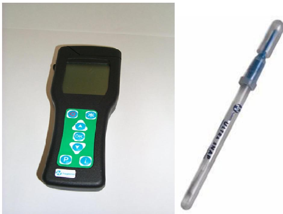
Рисунок 1 – Общий вид Люминометра System SURE Plus
