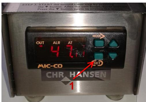
**3** Замигает буква t (установка температуры). С помощью треугольных кнопок установите температуру 47,5. Нажмите кнопку SET (1)
