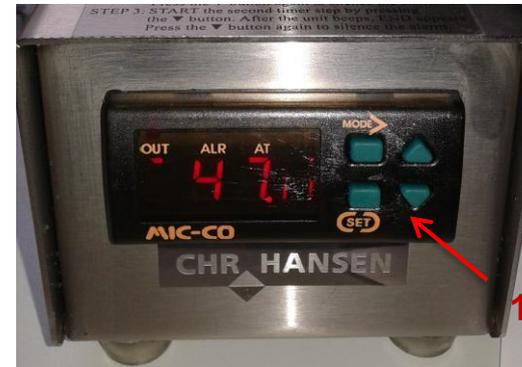
Нажмите на кнопку (1) – левая нижняя – несколько раз до полного выключения монитора термостата. (Должны исчезнуть все полоски слева от цифр)
