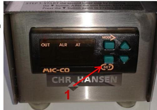
**4** Замигает буква t1 (установка времени). С помощью треугольных кнопок установите время 10. Нажмите кнопку SET (1)
