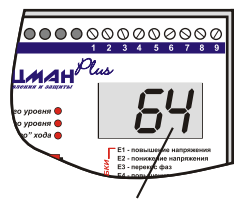
Значение рабочего тока электродвигателя
